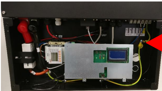
Figura 24 – Vite per il collegamento della massa del sistema di accumulo all'impianto di terra dell'utenza
