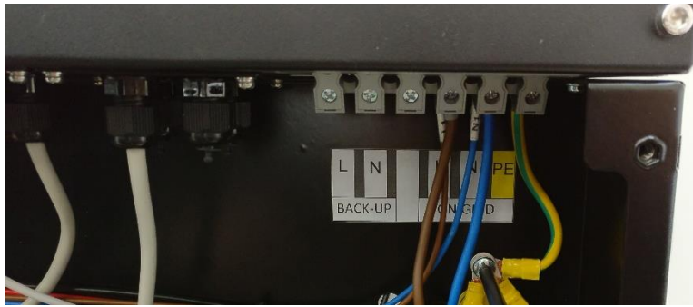
Figura 39 – Collegamento linea GRID sui morsetti denominati “ON-GRID”
