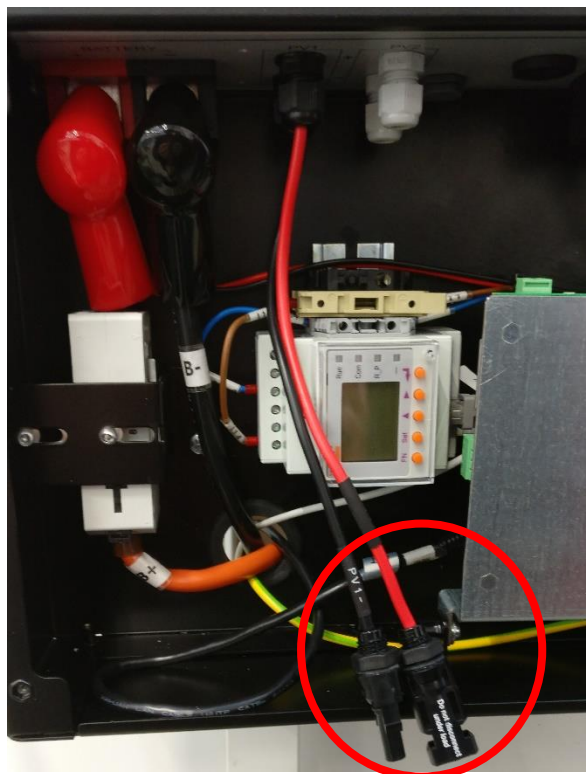
Figura 36 – Connettori MC4 interni al ATGxKTL
