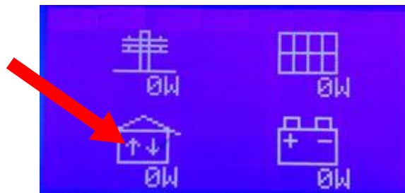
Figura 71 - Verifica della comunicazione attiva con il portale Aton
